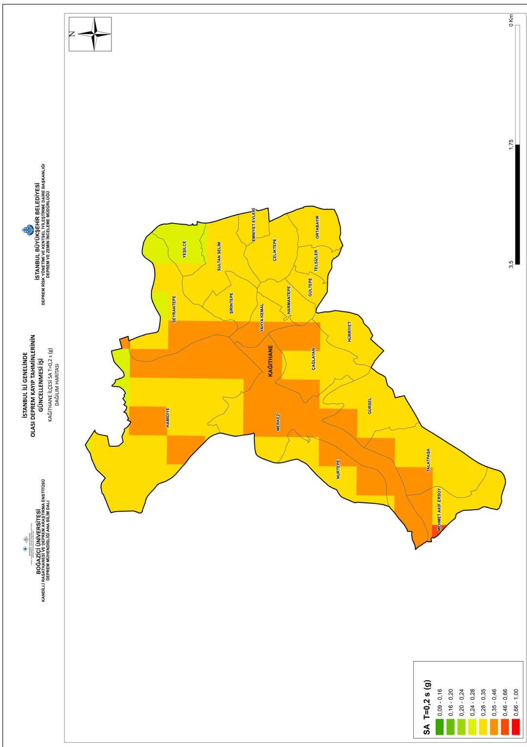
Şekil 4-6: Senaryo depremi için elde edilen Kağıthane İlçesi zemin bağımlı  $T=0.2$  s için Spektral ivme dağılımı
