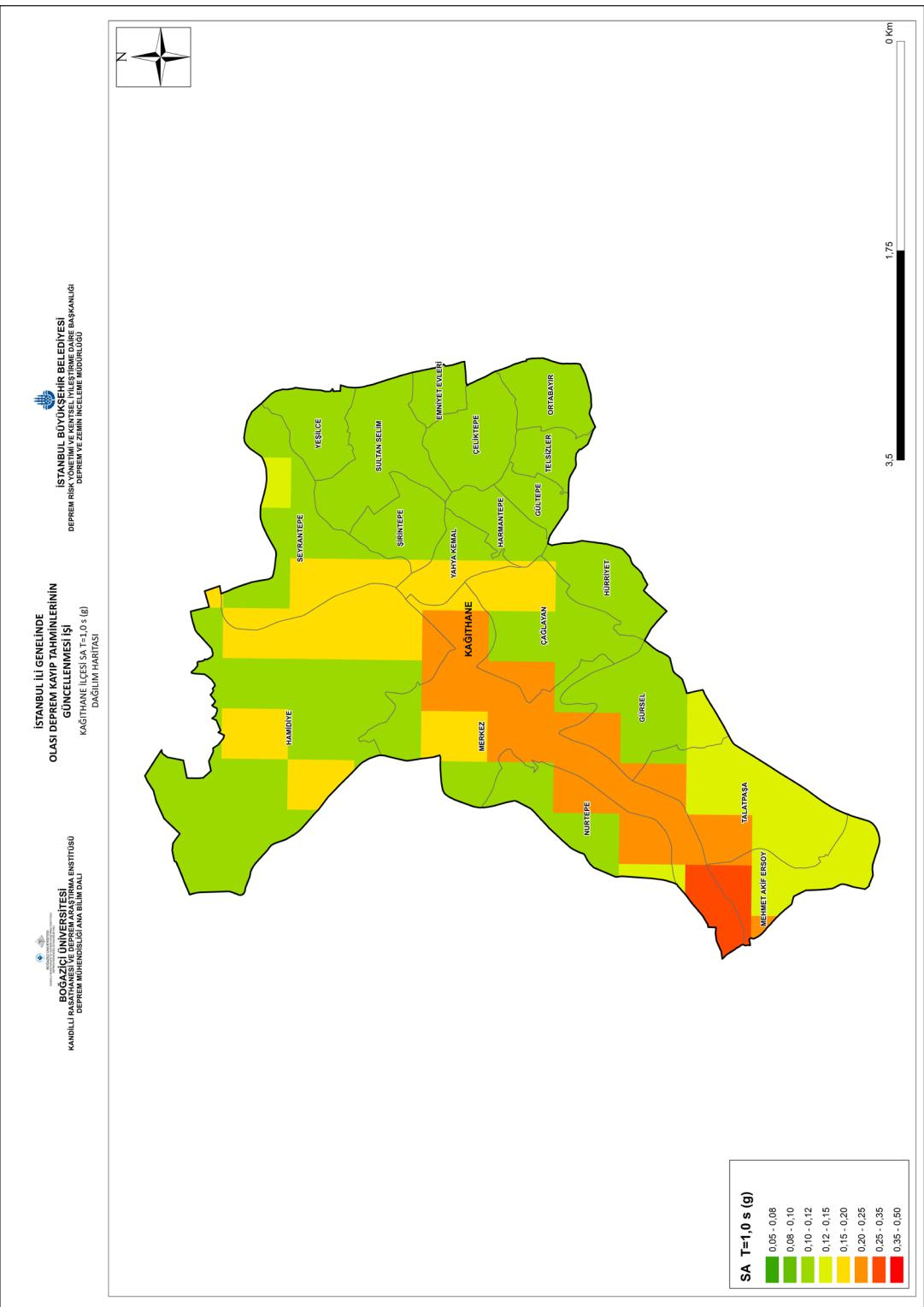
Şekil 4-7: Senaryo depremi için elde edilen Kağıthane İlçesi zemin bağımlı  $T=1.0\text{ s}$  için Spektral İvme dağılımı
